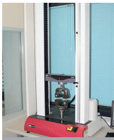
Le microduromètre Shimadzu et la machine d'essai Instron, chez le Centre de Bio-recherche Marco Pozzi, sont utilisés pour la vérification des caractéristiques mécaniques des fils.
