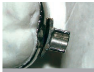
Les rebords du joint assurent l'union parfaite à la bague à l'aide d'une simple soudeuse
